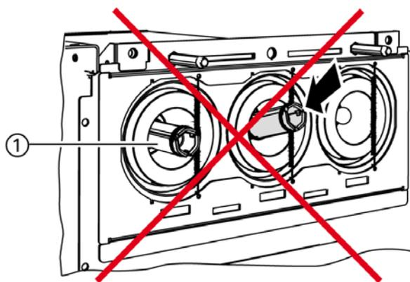
Рисунок 88: Неправильно установленный контактный элемент
