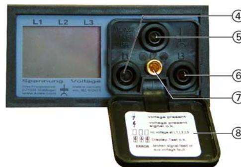
Рисунок 29: CAPDIS-S2+: Крышка снята
