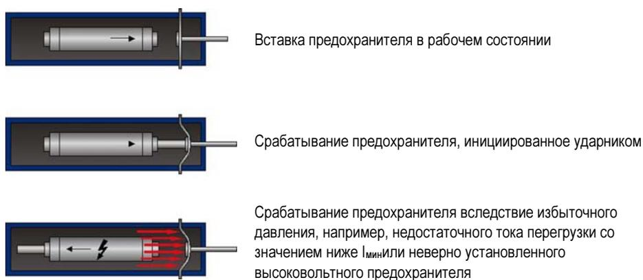
Кроме того, высоковольтные предохранители освобождают ударный стержень в зависимости от температуры и отключают трехпозиционный ВН в начале зоны перегрузки. Благодаря этому предотвращается недопустимый перегрев блока предохранителя.
