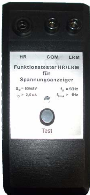
Рис. 63. Функциональное испытательное устройство для индикатора напряжения, номер для заказа: 8DX1506
