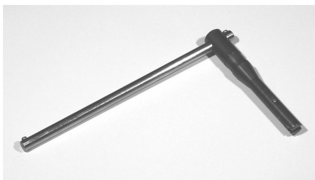
Рисунок 8: Инструмент для приведения в действие заземляющего выключателя на фидере. Для заземлителей с электроприводом инструмент имеет идентичную конструкцию, за исключением красной маркировки и поперечного штифта.
